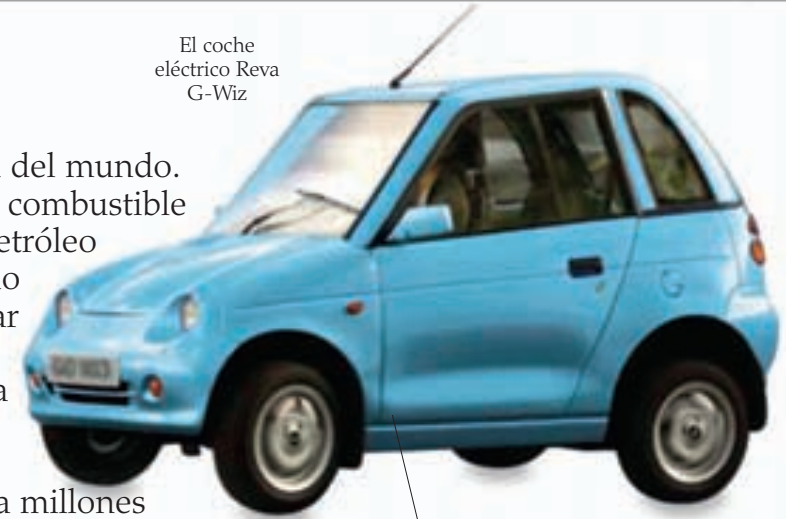
El G-Wiz tiene una autonomía de 64 km y una velocidad máxima de unos 64 km/h.
