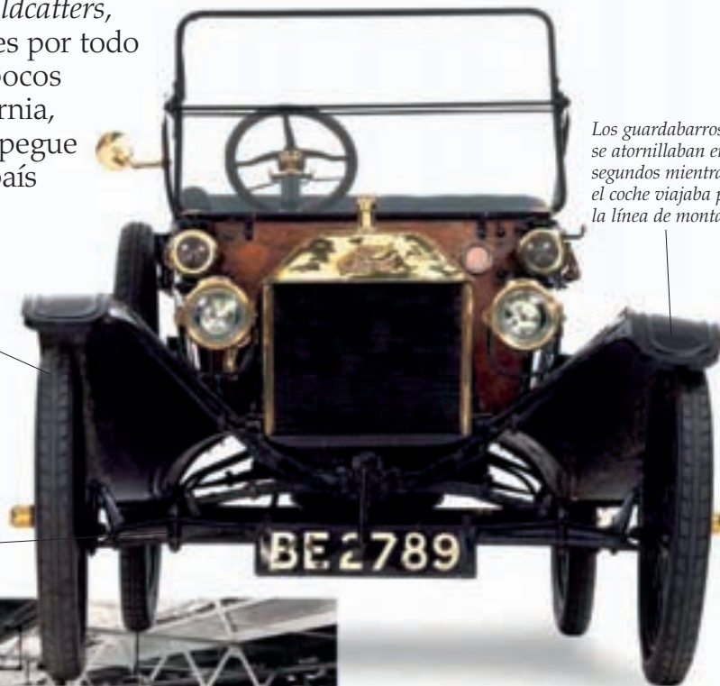
Las ruedas se colocaban en los primeros estadios del proceso de fabricación, lo que facilitaba la tarea de mover el chasis por la fábrica
