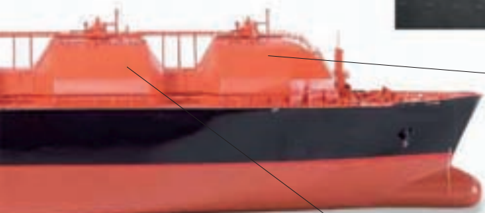
Los tanques preservan la presión para evitar que el gas licuado se evapore
