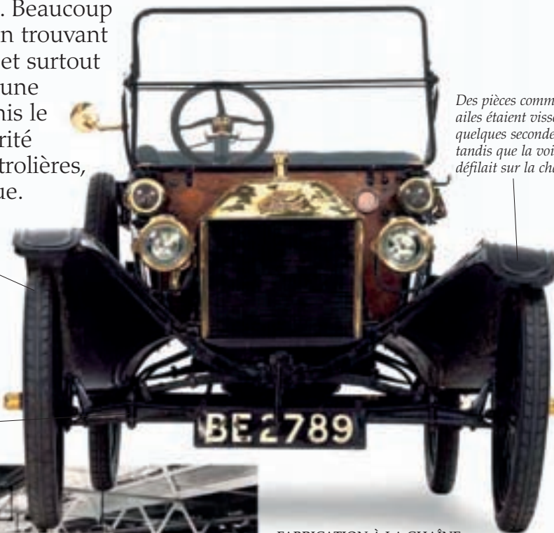
Les roues étaient fixées dès le début de la fabrication afin que le châssis puisse rouler facilement le long de la chaîne de production.
