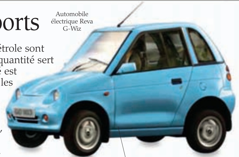
La G-Wiz a une autonomie de 64 km et une vitesse maximale de 64 km/h environ.
