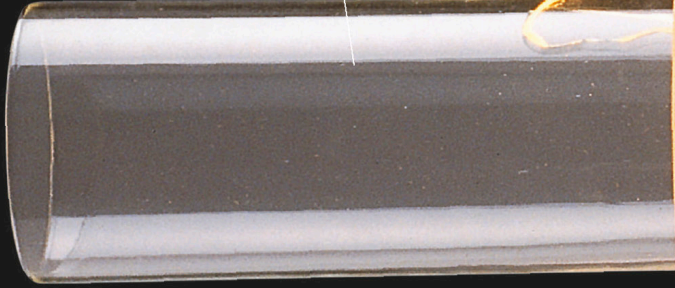
مدخنة زجاجية لحسين تدفق الهواء والحماية من التيارات الهوائية
