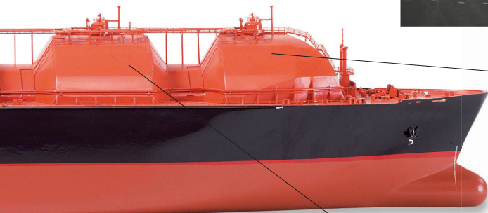
Versterkte tanks houden het gas onder druk en in vloeibare vorm
