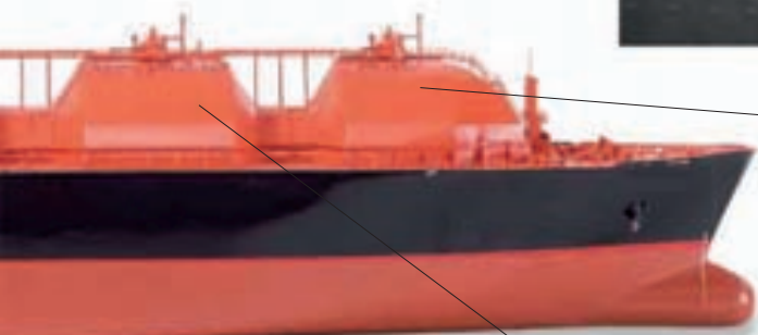
Os tanques reforçados preservam o gás pressurizado e na forma líquida
