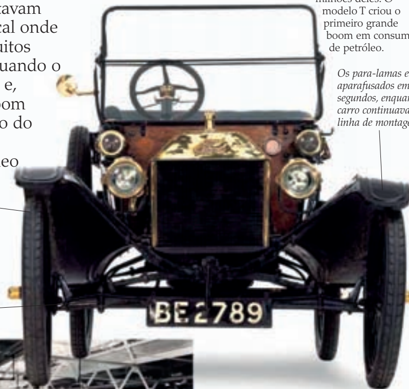
As rodas eram colocadas na primeira fase do processo de fabricação, o que facilitava o deslocamento do chassi pela fábrica
