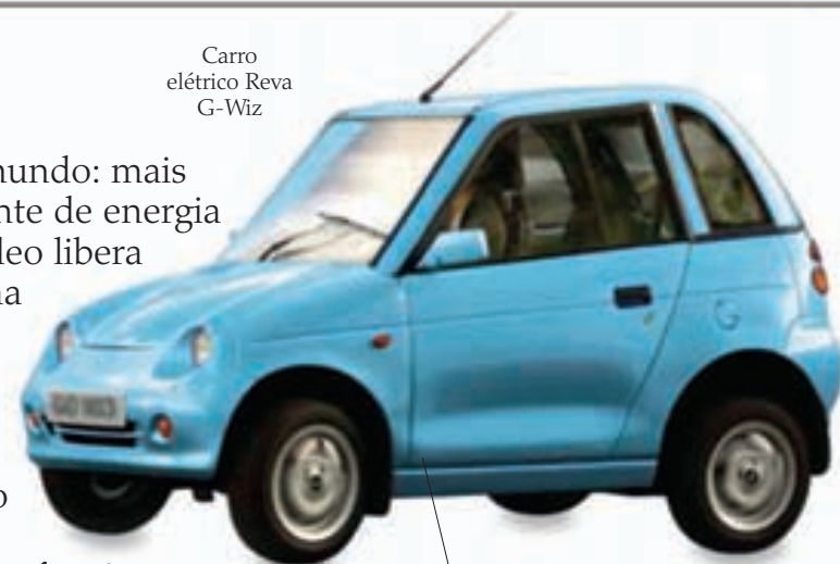
O G-Wiz tem autonomia de 64 km e alcança uma velocidade máxima de aproximadamente 64 km por hora
