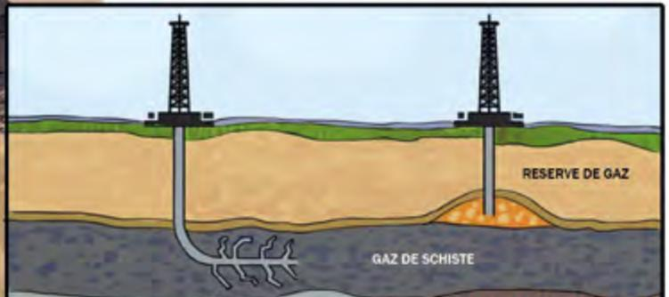
POUR LIBÉRER LE GAZ DE LA ROCHE-MÈRE IMPERMÉABLE, IL FAUT FORER VERTICALEMENT JUSQU'ÀUX COUCHES DE SCHISTES SITUÉES ENTRE 1500 ET 3000 MÈTRES, PUIS HORIZONTALEMENT. LA ROCHE EST FRACTURÉE PAR INJECTION SOUS HAUTE PRESSION D'UN MÉLANGE D'EAU ET DE SABLE. CETTE TECHNIQUE DE FRACTURATION HYDRAULIQUE EST UTILISÉE À GRANDE ÉCHELLE EN AMÉRIQUE DU NORD DEPUIS LES ANNÉES 2000.
